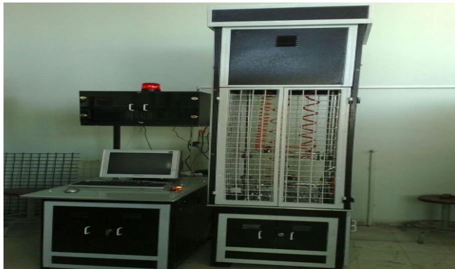
شکل ۵. دستگاه تست ضربه
