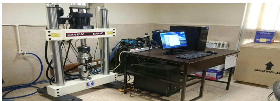
شکل ۶. دستگاه تست خستگی
