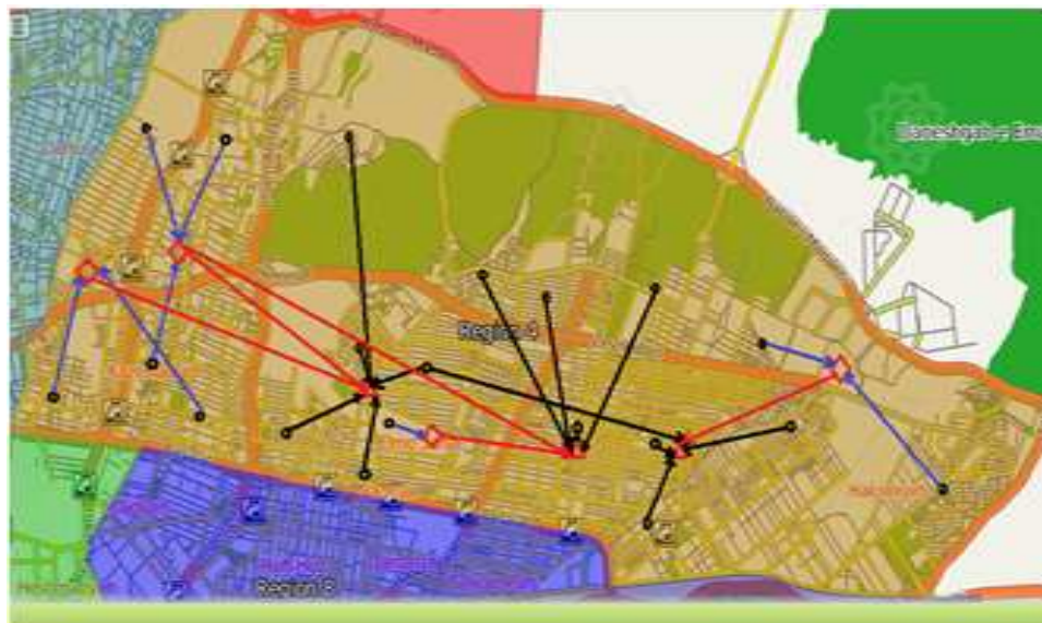
خطوط آبی نشان‌دهنده‌ی انتقال تقاضا از نقاط تقاضا به نقاط انتقال خطوط قرمز نشان‌دهنده‌ی انتقال تقاضا از نقاط انتقال به نقاط تسهیل خطوط سیاه نشان‌دهنده‌ی انتقال تقاضا از نقاط تقاضا به نقاط تسهیل
